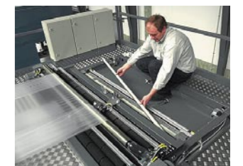
Fácil sustitución de la unidad de sellado y corte. Sin necesidad de herramientas. Sólo tiene que abrir el cierre, sacar la unidad de sellado magnético y sustituirla por otra de repuesto.
