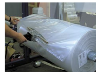
Cambio de film en el suelo. Sólo hay que pegar, grapar o sellar el extremo de la bobina nueva al final de la bobina antigua y la máquina dispensará automáticamente el film.
