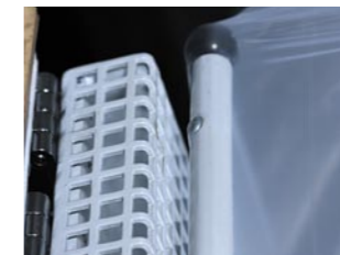
Pneumatische Greiferkontrolle. Stellt sicher, dass die Folie immer richtig an den Greifern platziert ist.
