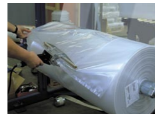
Einfacher Folienwechsel auf Bodenniveau. Das Ende der alten Folie wird einfach mit dem Ende der neuen verschweißt, geklebt oder geheftet und automatisch durch das Folienvorschubsystem geführt.
