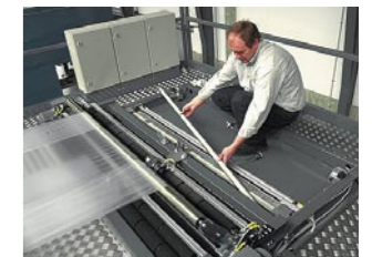
Einfacher Wechsel von Schweißeinheit und Foliennesser. Keine Werkzeuge erforderlich. Einfach die „Klick-Verriegelung“ öffnen und die magnetische Schweißeinheit herausziehen und durch eine neue ersetzen.
